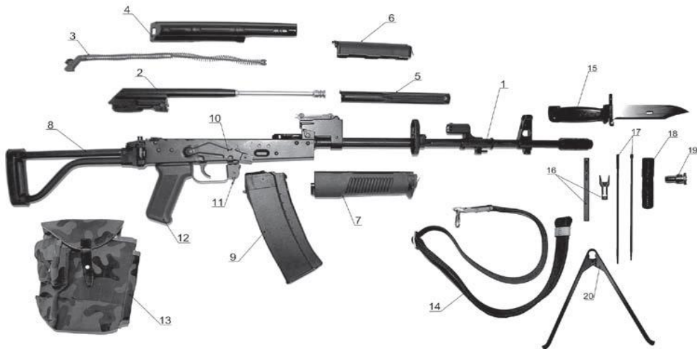
Rys. 1. a - Widok ogólny 5,56 mm karabinu szturmowego – wariant A;
